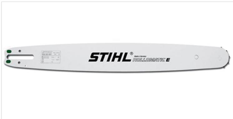
Spranga in versione standard con eccellente resa di taglio ma con limitata tendenza al rimbalzo. Impieghi principali: lavoro forestale, agricoltura ed edilizia ma anche hobbistica e impieghi occasionali. Corpo spranga composto da tre strati metallici saldati. Quello centrale è fortemente sfinestrato per garantire grande stabilità con peso molto favorevole. La catena scorre su una stella di rinvio con robusto supporto, intercambiabile e che non richiede lubrificazione.
